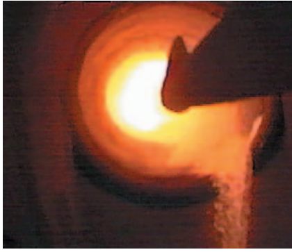
FlameSightVideo Bild aus einem Drehrohrofen (Zementindustrie)
